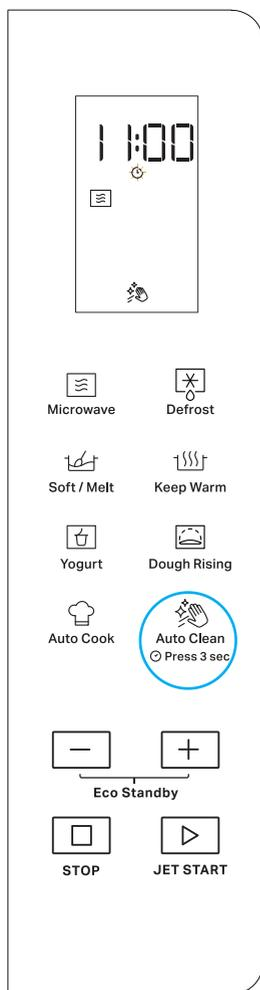
Le cycle de nettoyage automatique vous aidera à nettoyer l'intérieur du four pour éliminer les résidus et les mauvaises odeurs.
