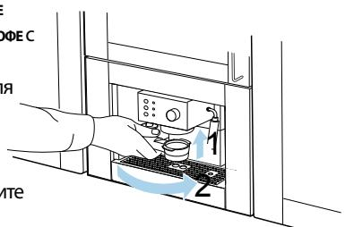
держатель фильтра к прибору. Поворачивайте держатель с усилием, чтобы избежать утечки воды.
