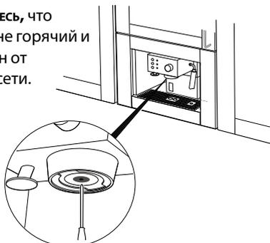
**2. С помощью отвертки** отвинтите винт, удерживающий фильтр выхода паровода для приготовления эспрессо.
