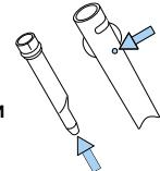
**6. Установите на место сопло подачи пара, вставив его в трубку подачи пара и с усилием повернув, нажимая в направлении верхней части трубы.**
