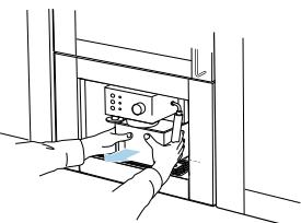
**ЗАПРЕЩАЕТСЯ ИСПОЛЬЗОВАТЬ ПРИБОР БЕЗ ВОДЫ В ЕМКОСТИ.** Не забывайте доливать воду, если ее уровень в емкости опускается до одного-двух сантиметров от дна.
