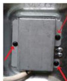
После прокладки провода электропитания завинтите металлическую крышку тремя винтами.
