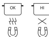
Слід застосовувати лише каструлі і сковороди, які виготовлено з феромагнітного матеріалу, що призначені для використання з індукційними варильними панелями. Щоб визначити, чи підходить каструля, перевірте наявність символу (звичай виштампуваний на дні). Перевіріть, чи є каструлі магнітними, можна за допомогою магніту. Якість і структура каструлі можуть змінити якість приготування.
