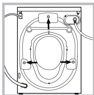
3. Отстранете 3-те защитни винта за предпазване при превоза и гумираната опаковка със съответния раздалечител, намиращи се в задната част (вижте фигурата).
