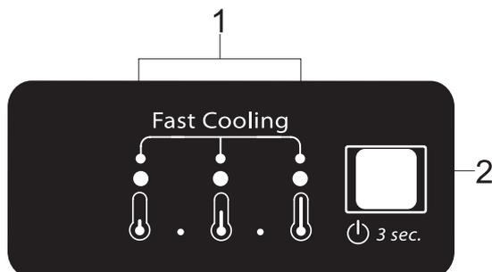
1. Anzeige-LEDs (zur Anzeige der aktuellen Temperatureinstellung oder der Schnellkühlfunktion)
