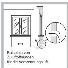
Angrenzender Raum Zu belüftender Raum Vergrößerung des Lichtspaltes zwischen Tür und Fußboden
