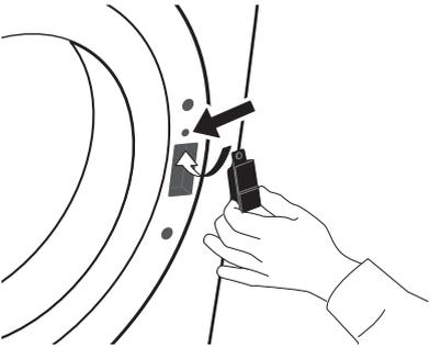
**7.** Die beiden Schrauben oberhalb und unterhalb der Türverriegelung festschrauben.
