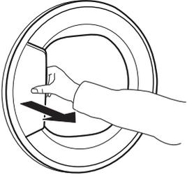
Zum Schließen der Tür, halten Sie den Griff und drücken Sie so, dass Sie die Verriegelung einrasten hören.
