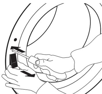
**4.** Entfernen Sie die 2 Schrauben auf dem Türscharnier und entnehmen Sie die Tür.
