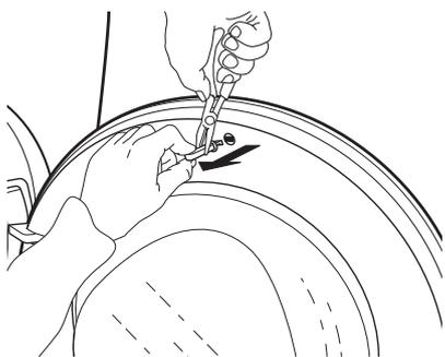
**2.** Die beiden Schrauben oberhalb und unterhalb der Türverriegelung herausdrehen.
