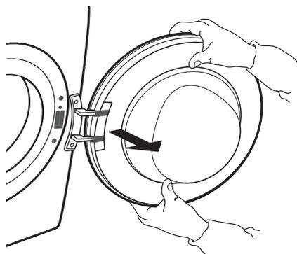
**5.** Befestigen Sie die Tür auf der linken Seite durch Eindrehen der 2 Schrauben. Die Schrauben vertikal festschrauben, um die Türdichtung nicht zu zerquetschen.
