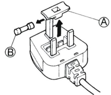
1. Sicherungsdeckel (A) entfernen und Sicherung (B) herausnehmen.
