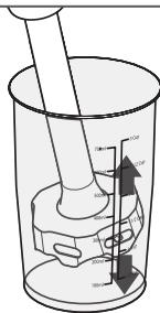
Za pomicanje sastojaka u posudi pomičite štapni mikser prema gore i prema dolje. Polako ga vucite prema gore uz rub posude. Ponavljajte postupak dok sastojci ne postignu željenu konzistenciju.
