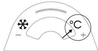
Befindet sich der Zeiger im rechten Bereich, muss die Kühlraumtemperatur vermindert werden.
