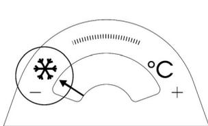
Befindet sich der Zeiger im linken Bereich, muss die Kühlraumtemperatur erhöht werden.
