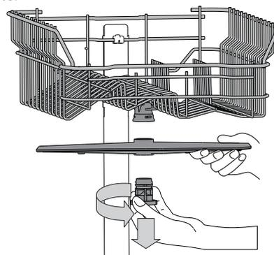
Zur Abnahme des oberen Sprüharms drehen Sie den Kunststoffring gegen den Uhrzeigersinn ab. Der obere Sprüharm ist mit jener Seite nach oben wieder einzusetzen, die die meisten Löcher aufweist.
