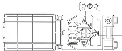
L'appareil doit être raccordé au secteur à l'aide d'un dispositif à coupure omnipolaire ayant une distance de 3 mm au moins entre les contacts.
