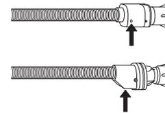
Para as mangueiras de corte de água: verifique a pequena janela de inspeção da válvula de segurança (ver seta). Se estiver vermelha, significa que a função de corte da água foi ativada e a mangueira deve ser substituída por uma nova. Para desapertar esta mangueira, prima o botão de libertação (se disponível) enquanto desaperta a mangueira.
