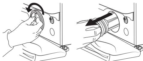
10. Limpe o filtro de água: remova os resíduos do filtro e limpe-o sob água corrente.
