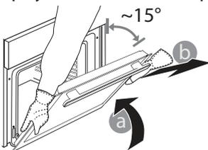
3. Vuelva a instalar la puerta llevándola hacia el horno, alineando los ganchos de las bisagras con sus alojamientos y fijando la parte superior en su alojamiento.
