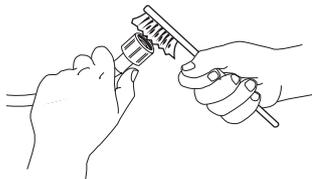
3. Dévissez ensuite à la main le tuyau d'alimentation au dos du lave-linge. Sortez le filtre à tamis de la soupape au dos du lave-linge avec des pinces et nettoyez-le soigneusement.
