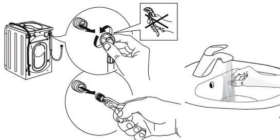
4. Remplacez le filtre à tamis. Rebranchez le tuyau d'alimentation au robinet d'eau et au lave-linge. N'utilisez pas d'outils pour brancher le tuyau d'alimentation. Ouvrez le robinet d'eau et assurez-vous que tous les raccords sont bien serrés.
