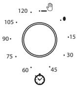
Med denne bryteren kan du stille inn en tilberedningstid mellom 1 og 120 minutter. For å stille inn tilberedningstiden dreier du bryteren helt rundt med urviserne og dreier den deretter tilbake i motsatt retning til ønsket tilberedningstid etter at du har aktivert en eller begge kokeplatene.
