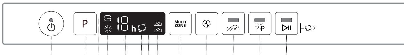
1. Dugme za uključivanje-isključivanje/ponovno podešavanje sa svetlosnim indikatorom
