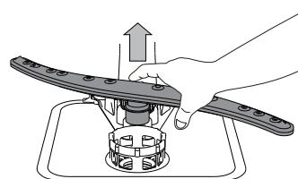
Spodní ostřikovací rameno lze vyjmout zatažením směrem nahoru.
