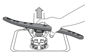
Brațul de pulverizare inferior poate fi demontat prin tragerea în sus.
