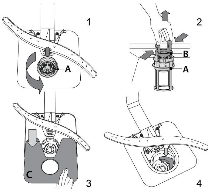
Nakon čišćenje filtara vratite sklop filtra i pravilno ga učvrstite na mjesto; to je važno za održavanje učinkovitog rada perilice suđa..
