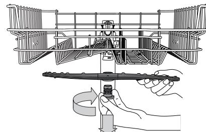
A felső szórókar leszereléséhez forgassa el a műanyag rögzítőgyűrűt az óramutató járásával megegyező irányba. A felső szórókar visszahelyezésekor ügyeljen arra, hogy a több nyílást tartalmazó oldala nézzen felfelé.
