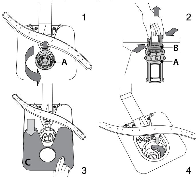
Nakon čišćenja filtera, ponovo postavite sklop filtera i pravilno ih pričvrstite na mesto; ovo je neophodno za efikasan rad mašine za pranje sudova.
