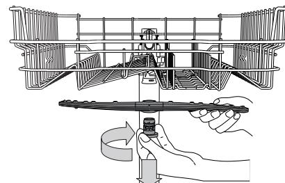
Pentru a demonta brațul de pulverizare superior, rotiți inelul de fixare din plastic în sens orar. Brațul de pulverizare superior trebuie introdus astfel încât partea cu cele mai multe orificii să fie îndreptată în sus.
