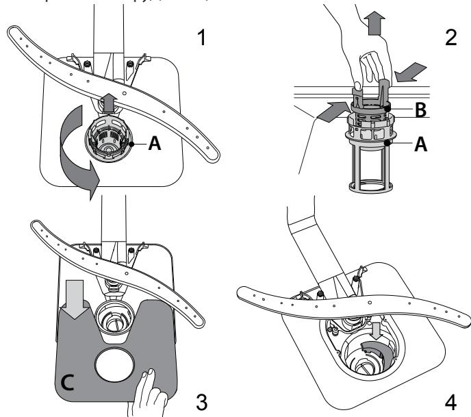
Після очищення фільтрів встановіть вузол фільтра на місце та закріпіть його у цьому положенні належним чином; це дуже важливо для ефективного функціонування посудомийної машини.
