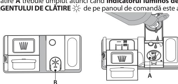
1. Deschideți dozatorul **B** apăsând și trăgând în sus clapeta de pe capac.
