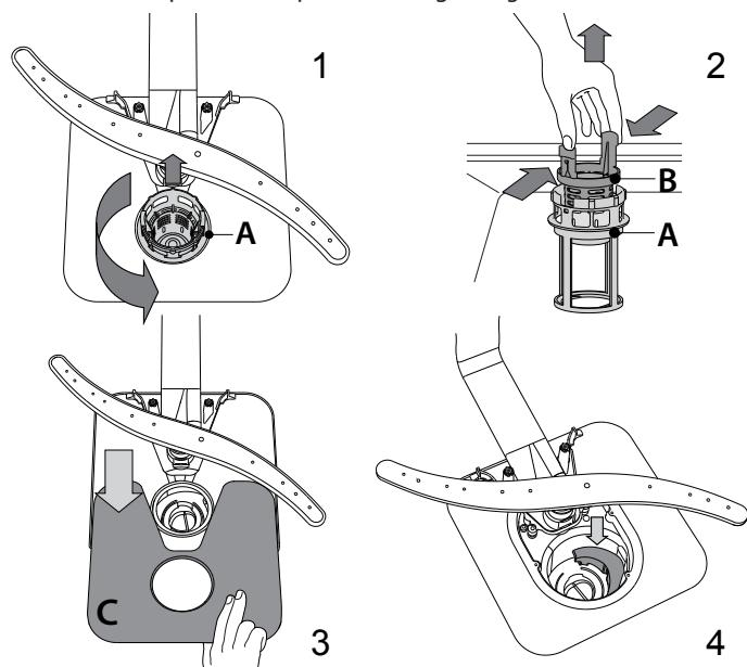
După curățarea filtrelor, montați la loc ansamblul de filtre și fixați-l în poziția corectă; acest lucru este esențial pentru menținerea funcționării eficiente a mașinii de spălat vase.
