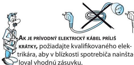
**AK JE PRÍVODNÝ ELEKTRICKÝ KÁBEL PRÍLIŠ KRÁTKY**, požiadajte kvalifikovaného elektrikára, aby v blízkosti spotrebiča nainštaloval vhodnú zásuvku.
