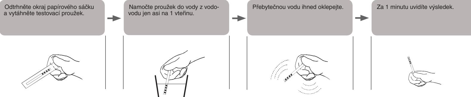
Na testovacím proužku jsou 4 zelené čtverečky, které se mění na červené v závislosti na tvrdoši vody:domácnosti:
