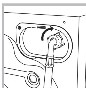
2. Συνδέστε το σωλήνα τροφοδοσίας στο πλυντήριο βιδώνοντάς τον στην αντίστοιχη είσοδο νερού, στο πίσω μέρος επάνω δεξιά (βλέπε εικόνα).
