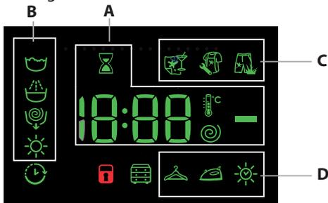
La section **A** affiche la durée des différents programmes disponibles et, une fois le cycle lancé, le temps restant jusqu'à la fin du programme ; si un DÉPART DIFFÉRÉ a été sélectionné, le temps restant avant le démarrage du programme sélectionné est affiché.
