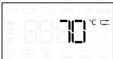
Se o termómetro de carne for ligado durante a seleção de uma função, o visor muda para a temperatura pretendida predefinida para o termómetro de carne.
