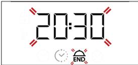
Utilice + o - para ajustar el tiempo deseado de finalización de cocción y pulse
