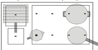
7. Sélectionnez la zone de cuisson sur l'afficheur gauche. Un "A" s'affiche dans la zone sélectionnée. Les zones disponibles qui sont recommandées pour positionner l'ustensile apparaissent à l'écran.
