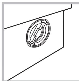
2. odkrącić pokrywę, obracając ją w kierunku przeciwnym do ruchu wskazówek zegara (patrz rysunek): wypłynięcie niewielkiej ilości wody jest normalnym zjawiskiem;
