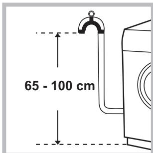
Podłączyć przewód odpływowy, nie zginając go, do rury ściekowej lub do otworu odpływowego w ścianie, które powinny znajdować się na wysokości od 65 do 100 cm od podłogi;
