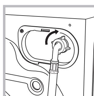
2. Besleme hortumunu arka kısmda üst sağ köşedeki su girişine vidalayarak çamaşır makinesine takınız (bkz. şékil).
