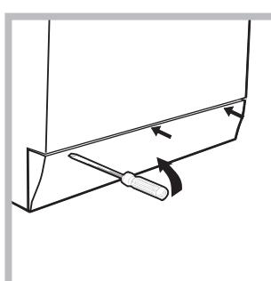
1. scoateți panoul de acoperire din partea din față a mașinii de spălat folosind o surubelnită (*a se vedea figura*);
