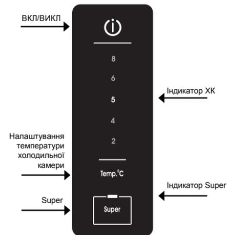
**ВКЛ/ВИКЛ** - натисканням цієї кнопки можна включити весь прилад в цілому (як холодильну, так і морозильну камери). Для відключення холодильника достатньо натиснути кнопку.
