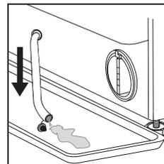
3. Rode a pega do filtro de saída e retire-o para fora do alojamento. Quando o recipiente do rodapé estiver cheio de água, coloque a tampa na extremidade da mangueira e reintroduza a pequena mangueira na base da máquina de lavar. De seguida, esvazie o recipiente.
