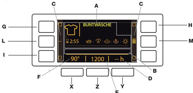
Nell'area **A** vengono visualizzati l'icona e il programma selezionato, le fasi di lavaggio e asciugatura e il tempo residuo alla fine del ciclo. Nell'area **B** vengono visualizzati i due livelli di intensità relativi all'opzione AZIONE PULENTE. Nelle aree **C** sono presenti le spie relative alle funzioni disponibili. Nell'area **D** viene visualizzato il tempo mancante all'avvio del programma selezionato nel caso fosse stato impostato una AVVIO RITARDATO.
