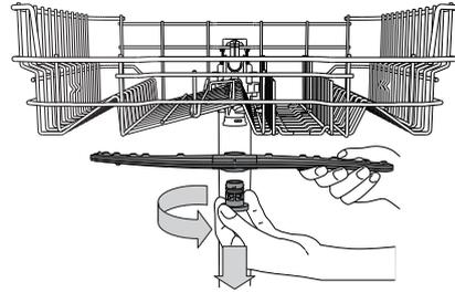
Pour enlever le bras d'aspersion supérieur, tournez l'anneau de verrouillage en plastique dans le sens antihoraire. Le bras d'aspersion supérieur doit être replacé de façon que le côté avec le plus grand nombre de trous est placé vers le haut.
