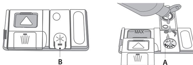
1. Ouvrez le distributeur **B** en appuyant et en tirant sur l'onglet sur le couvercle.
