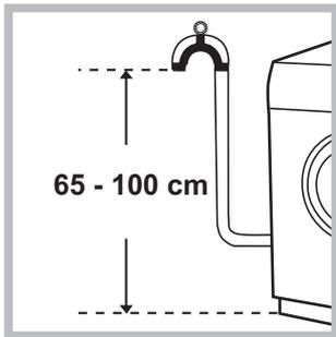
Bez savijanja spojite odvodnu cijev na odvodni cjevovod ili odljev u zidu, koji moraju biti u visini od 65 do 100 cm od poda;
