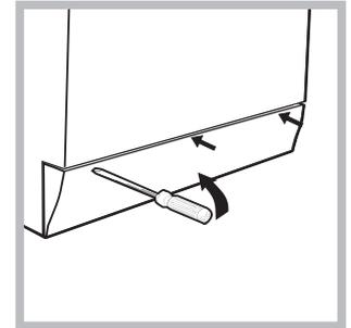
2. provjerite da je razina vode u unutrašnjosti stroja niža od otvora vrata; u suprotnom, pomoću odvodne cijevi ispraznite višak vode u kantu, kako je prikazano na slici;
