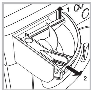
Izvučite pretinac podižući ga i povlačeći prema vani (vidi sliku). Operite ga u tekućoj vodi; ovo čišćenje treba često vršiti. frequently.
