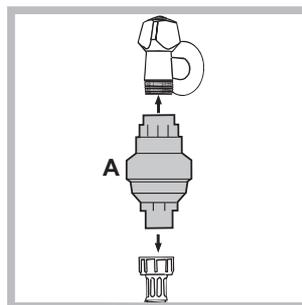
Приєднайте до водопровідного крана із холодною водою, за допомогою фітинга з газовою різьбою 3/4, пристрій **A**, після чого прикрутіть до нього трубу подачі.
