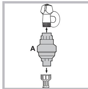
1. Povezivanje hladnu vodu iz slavine s navojem 3/4 plina ulaznog uređaja **A**, zatim spojite na njega vijcima dovodnom. Prije povezivanja, pokrenite vodu dok se ne radi jasno.
