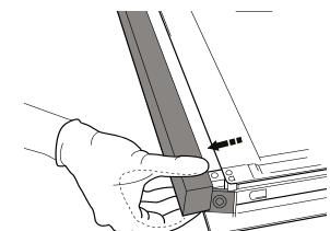
**3.** Внутреннее стекло установлено правильно, если в левом углу видна буква "R", а прозрачная поверхность (без принта) смотрит вверх. Сначала вставьте в пазы (a) длинную сторону стекла с буквой "R", затем опустите его в положение (b).
