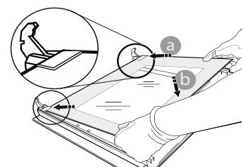
**4.** Зафиксируйте верхний край: Щелчок означает правильную установку. Перед установкой дверцы проверьте целостность уплотнения.
