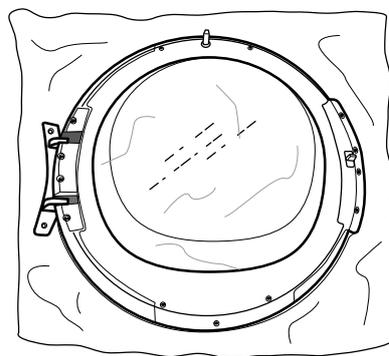
**5.** Desaperte o parafuso inferior, para soltar a moldura da parte frontal da porta.
