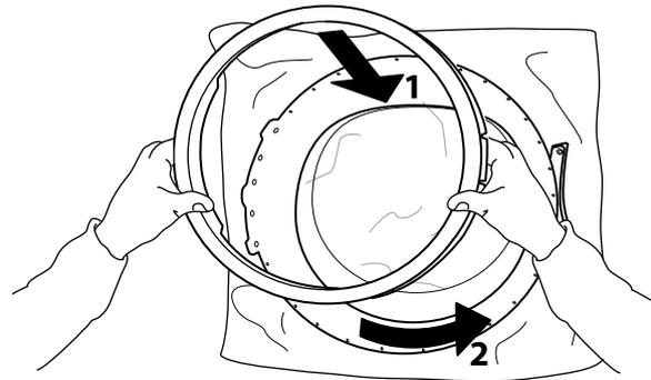
**17.** Vire novamente a porta e coloque-a voltada para baixo. Aperte novamente o parafuso inferior.
