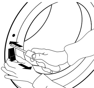
Para remover e fixar a porta, recomenda-se a ajuda de outra pessoa. Assegure-se de que a máquina de secar está desligada da tomada. Abra a porta da máquina de secar.
