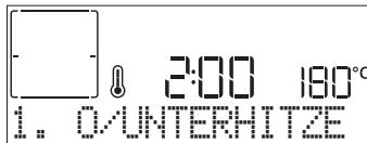
+ oder — zur Auswahl der Funktion verwenden, durch Drücken von ✓ bestätigen und anschließend
