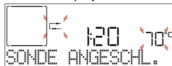
Wählen Sie die gewünschte Funktion aus denen, die kompatibel sind (Ober- & Unterhitze, Heißluft, Umluft, Grill + Heißluft, ECO Heißluft, Maxi Cooking, 6<sup>th</sup> Sense-Funktionen): Auf dem Display wird dazu aufgefordert, die Zieltemperatur des Kerntemperaturfühlers einzustellen: Drücken Sie + oder - zur Einstellung und ✓, um die folgenden Garparameter einzustellen.
