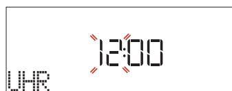
+ oder — drücken, um die aktuelle Uhrzeit einzustellen und ✓ drücken: Auf dem Display blinken die beiden Minutenziffern.
