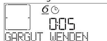
Ein akustisches Signal ertönt und das Display zeigt an, welche Tätigkeit auszuführen ist. Öffnen Sie die Tür, um die über das Display geforderte Tätigkeit auszuführen. Schließen Sie die Tür und drücken Sie dann ▶, um den Garvorgang fortzusetzen.
