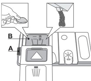
**Per aprire il distributore detersivo utilizzare il dispositivo di apertura A. Versare il detersivo esclusivamente nel distributore B asciutto.**
