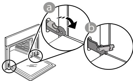
**2.** Прикройте дверцу, насколько это возможно. Надежно захватите дверцу обеими руками (не за ручку). Снимите дверцу, одновременно закрывая и смещая ее вверх. Положите дверцу на мягкую поверхность.
