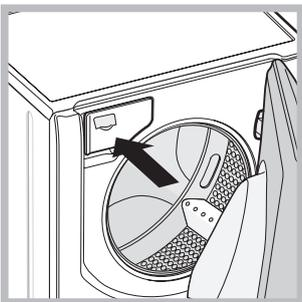
Il cassetto detersivi si trova all'interno della macchina e vi si accede aprendo la porta. Per il dosaggio dei detersivi vedi il capitolo "Detersivi e biancheria".
