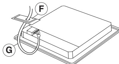
**Uredaj priključite na električno napajanje pomoću višepolnog prekidača za iskopčavanje s razmakom između kontakata najmanje 3 mm.**
