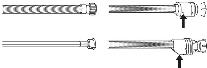
Se il tubo di carico ha un rivestimento trasparente, controllare periodicamente che non vi siano zone di colore più intenso. In questo caso, è possibile che il tubo presenti una perdita e debba essere sostituito.
